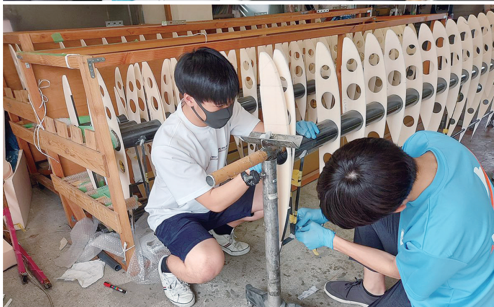
翼の作成作業=いずれもクラブ工房で
